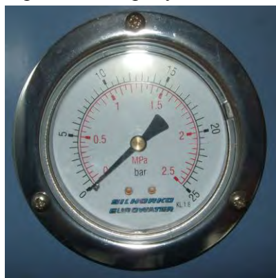
Рисунок 1. Манометр показывающий деформационный МВ 100
