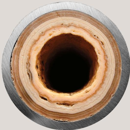
Умягчение предотвращает отложения кальция, в трубопроводах, паровых котлах, системах централизованного теплоснабжения, водонагревателях, теплообменниках и градирнях. Можно избежать традиционного использования химических реагентов для связывания кальция. Другими словами, умягчение может оптимизировать использование энергии в котлах и установках горячего водоснабжения, минимизировать использование химических реагентов и продлить срок службы установок и станций.
